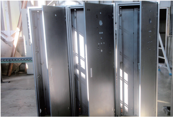
加工完成した機器取付パネル
