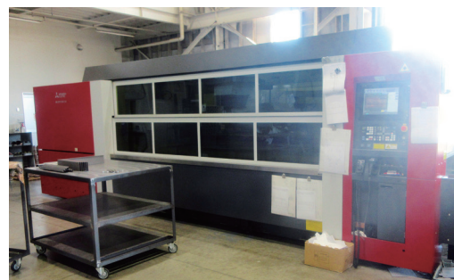
電盤、配電盤等の板金加工作業加工機
