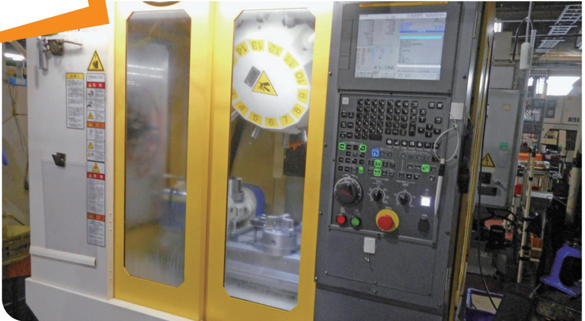
導入した5軸小型マシニングセンターロボドリルα-D14MiB5
