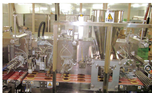
餡充填・耳締め機 SDR-AM-24A
