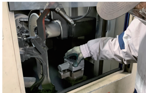
バリンダーによる仕上げ作業
