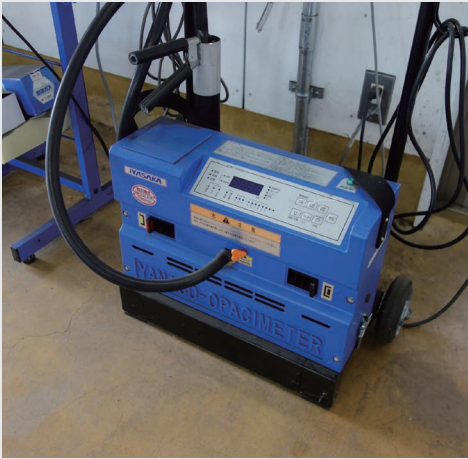
▲オパシメータ。ディーゼル車の排気ガスを計測。
