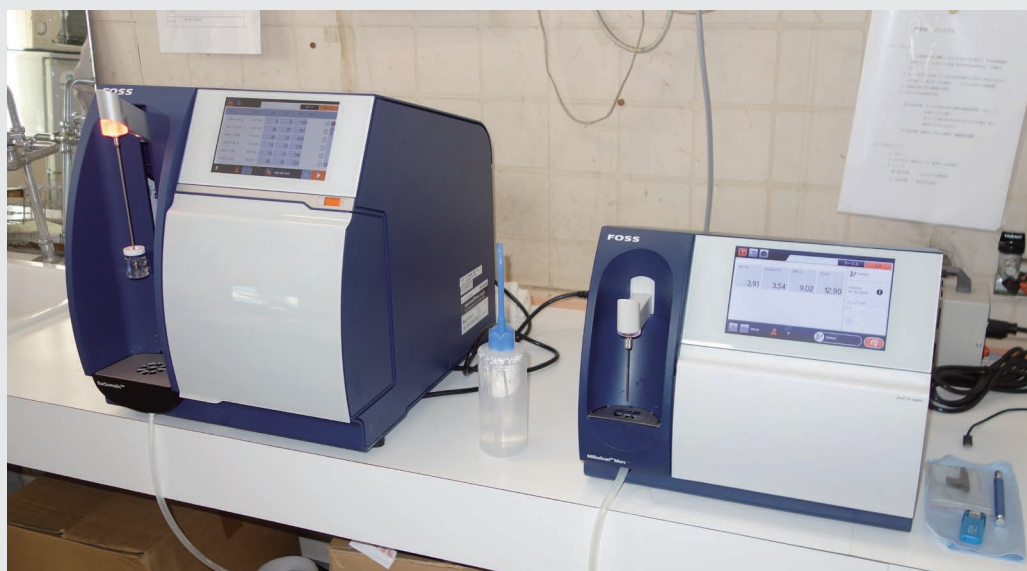
◀検査室に導入された 最新型細菌数／体細胞数測定装置と 最新型乳成分測定装置
