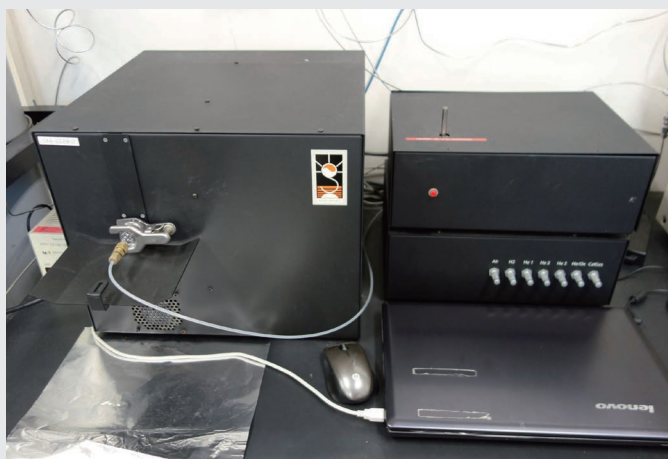
▲カーボンエアロゾル分析装置(既存設備)。 PM2.5の成分の一つである炭素を分析する。
