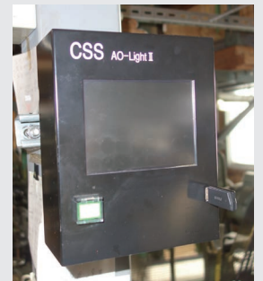
▲USBから柄データをジャカードに送るコントローラー
