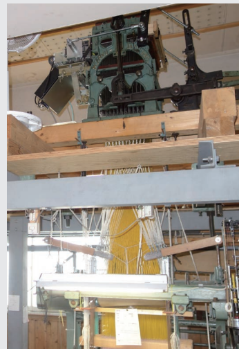
◀▲ダイレクトジャカード。 旧来のジャカードに柄データを読み込ませる装置
