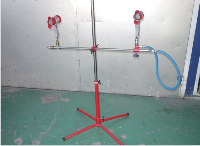
▲塗装乾燥用送風機。拡散した風を塗装面に広げ、短時間で乾燥を促す。
