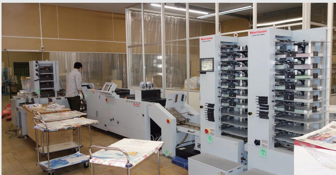
◀中綴じ機。 2穴加工、ペラ差し込みも 自動化されている。
