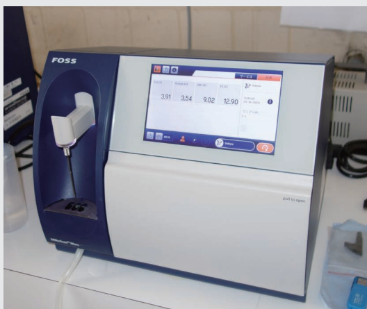
▲乳成分測定装置。 乳脂肪、無脂乳固形などを測定限界0.01%の高精度で測定
