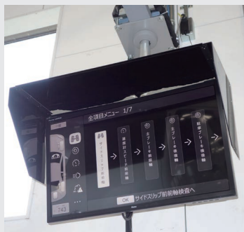
◀▲完成検査ラインの制御盤とモニター。 オンライン化で「見える化」を実現
