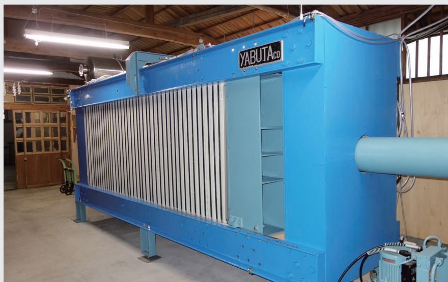
▲ポリプロピレン製の濾過板・圧搾板に変更したフィルタープレス型圧搾機（藪田式自動圧搾機改良）
