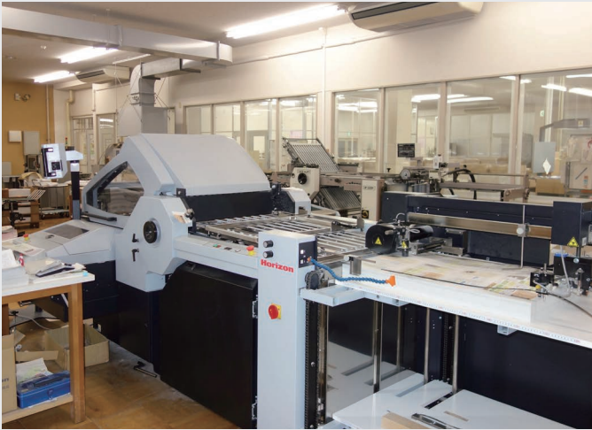
▲紙折機(菊全版)。自動化により調整時間が大幅に短縮された。
