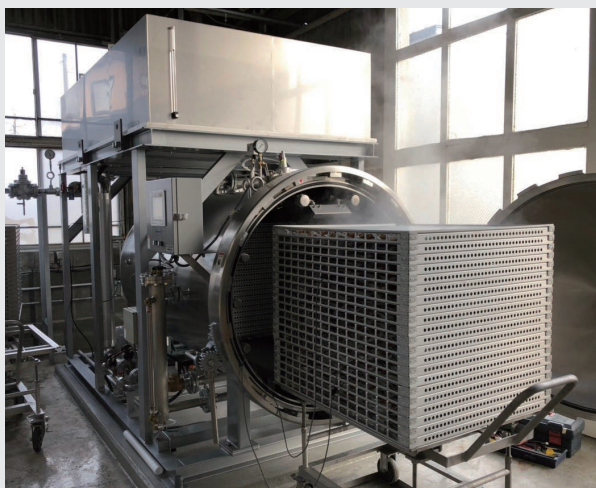
▲熱水噴流式調理殺菌装置。中心部120℃までの加圧加熱殺菌を施す。
