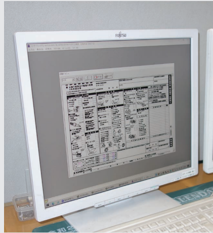
▲自動車整備業システムとの連結により、各検査機器の数値が記録簿等に自動入力される。
