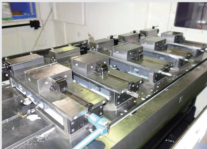
▲2パレット仕様のためバイスの着脱が不要となり、作業効率、生産性が向上
