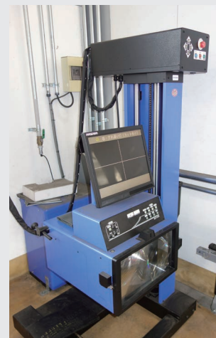
▲ヘッドライトテスト。 全自動計測が可能
