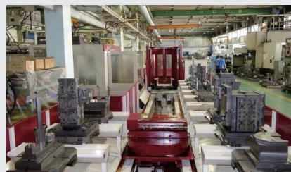
◀◀ キャリアがパレットを直線的に搬送。 移動時間を短縮
