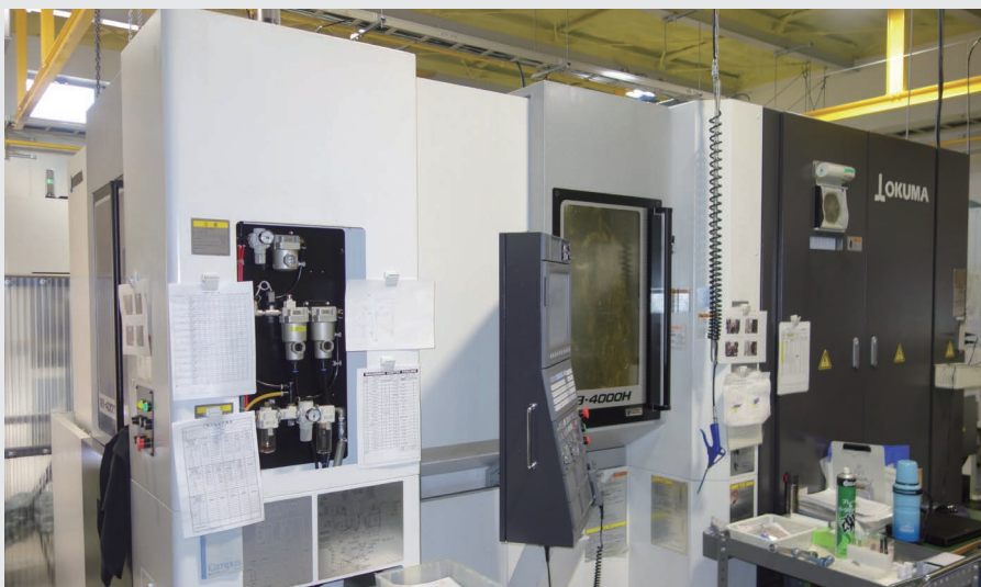
▲横形マシニングセンタ(環境熱変位制御装置付)
