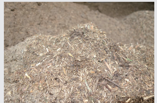
▲破砕後、ふるいで選別された木材チップ。 畜産の敷料や木質バイオマス発電所の燃料に。
