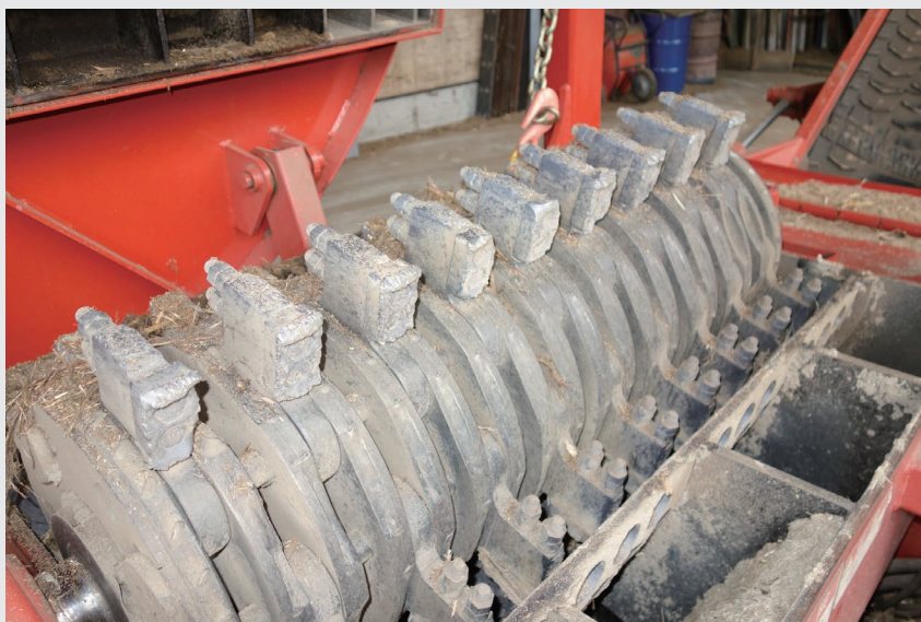
◀木材破砕機の心臓部。破砕ハンマーが高速回転し、木材を粉砕する。
