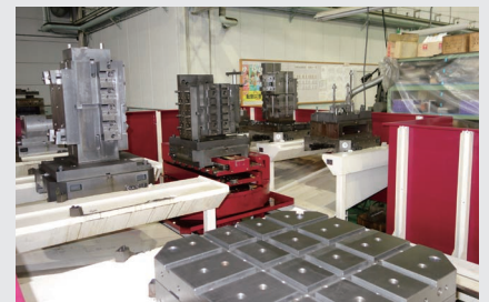
◀◀ キャリアがパレットを直線的に搬送。 移動時間を短縮
