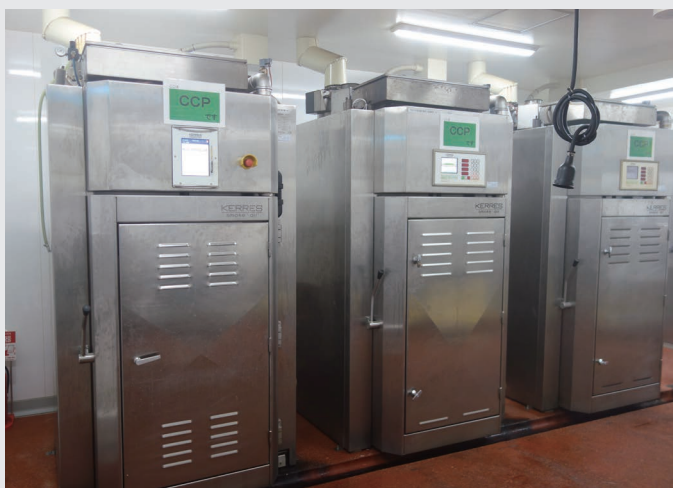
▲スモークハウス増設(左)。温度調節からスモーク加工まで自動で行う。
