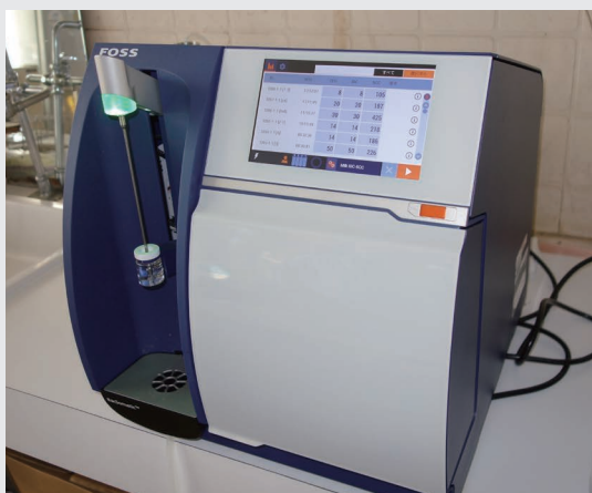
▲最新型細菌数／体細胞数測定装置。 低レベルの細菌数、体細胞数でも高精度に同時に測定可能。
