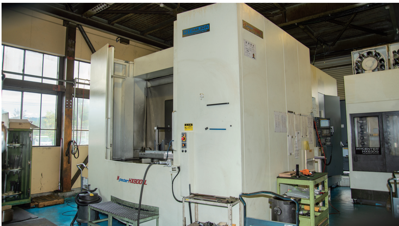
大型の製品を加工できるマシニングセンタ
