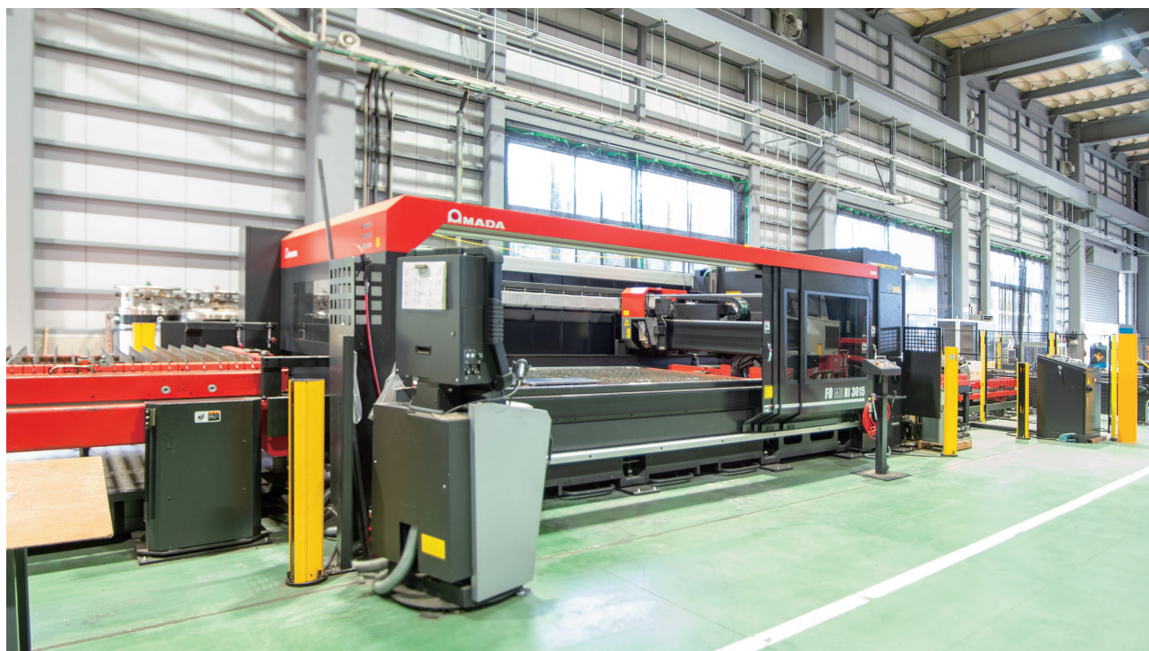
形鋼を切断する3次元レーザー加工機。形鋼プラモデル工法に最適なシステム
