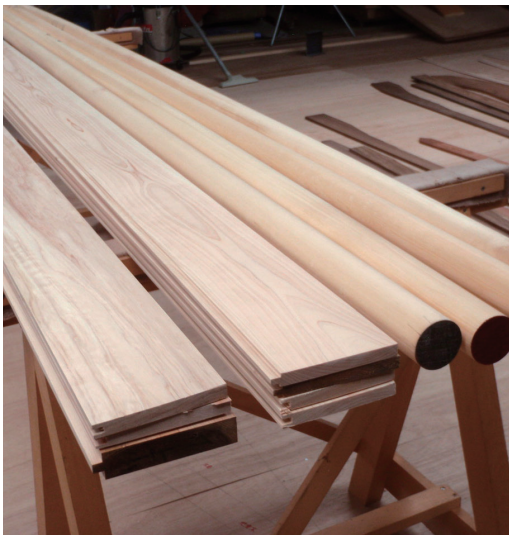
加工した木材。手作業で四角い木材を架木(丸い棒状の物)にするまでには技術の習得に時間がかかっていた
