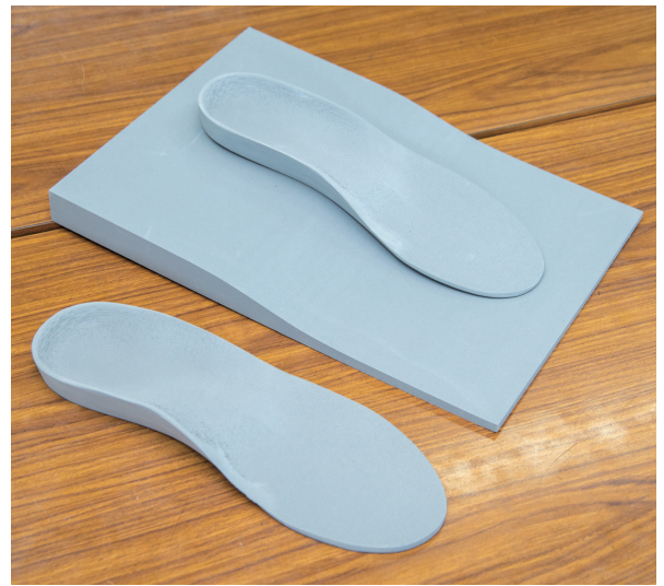
インソールの材料を切削機に入れ、自動で切削される(1足分)
