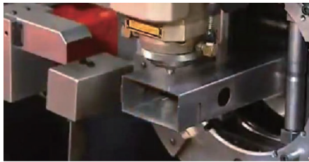
レーザー光線で穴あけ、切欠きをする
