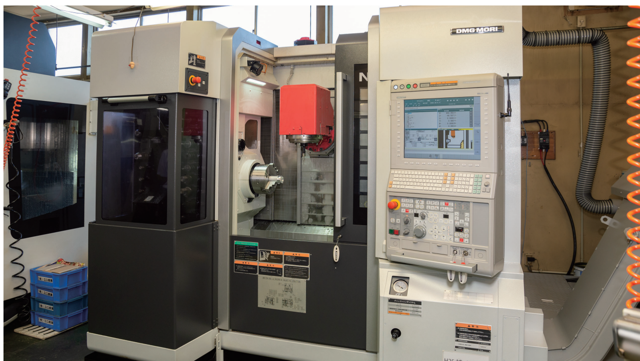
1行のプログラミング変更も可能な、高精度NC旋盤複合加工機
