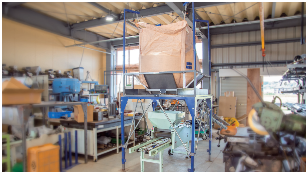
3DCADを活用し開発した「フレコンパレット」と「フレコン用フレーム(台座)」農家の納屋の高さを考慮し、重量は1トンまで耐えられる設計にした
