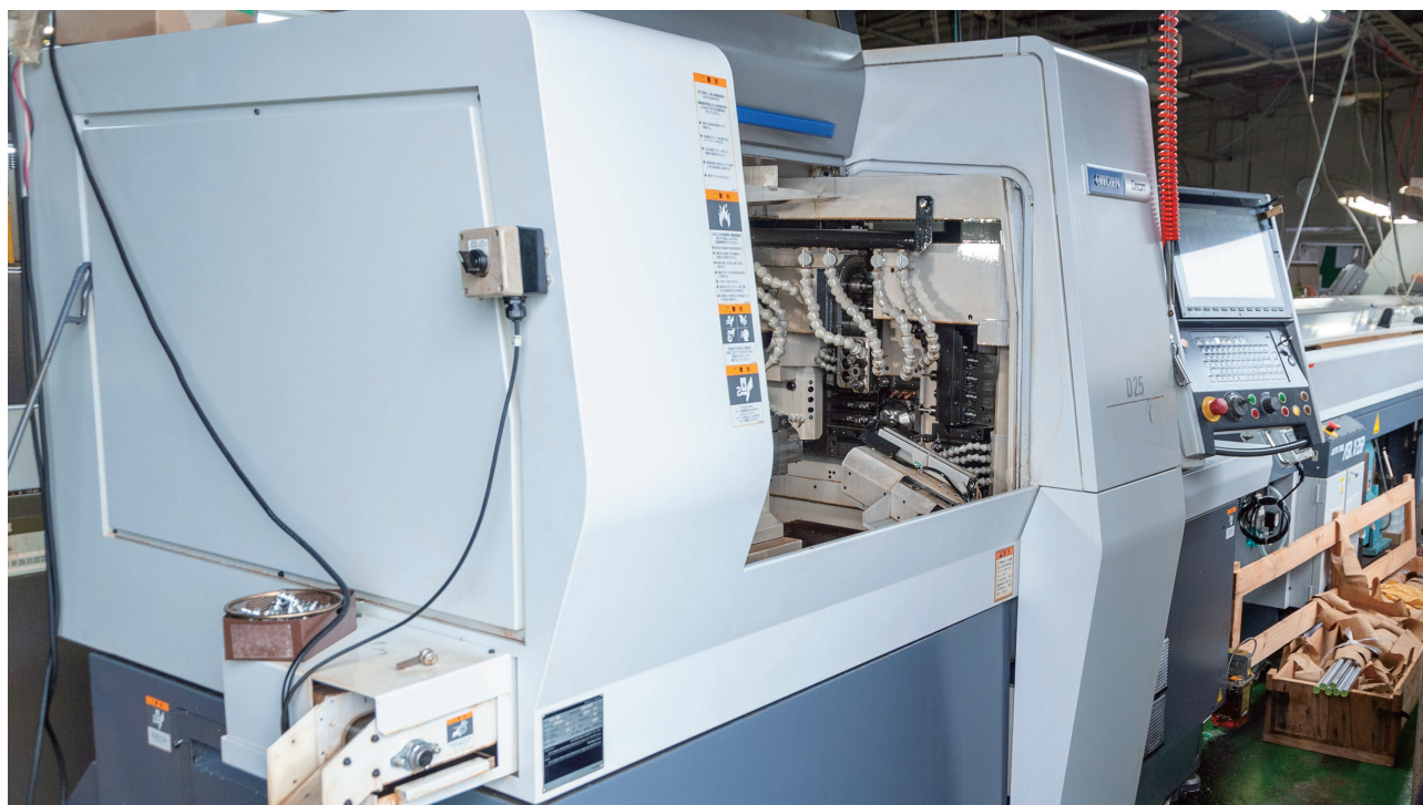
導入した偏芯加工可能多軸旋盤1台で偏芯部品が1次加工のみで完成品になる
