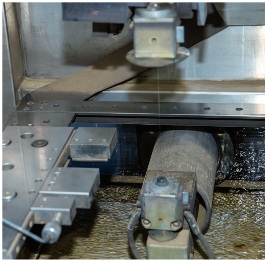
ワイヤー放電加工で高精度湾曲形状が可能
