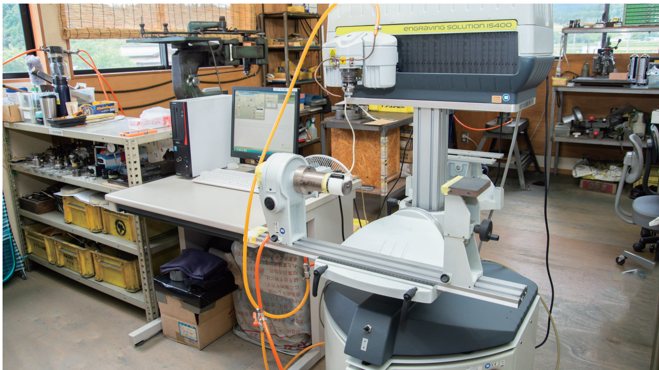
平面、曲面に対応できるNC彫刻機
