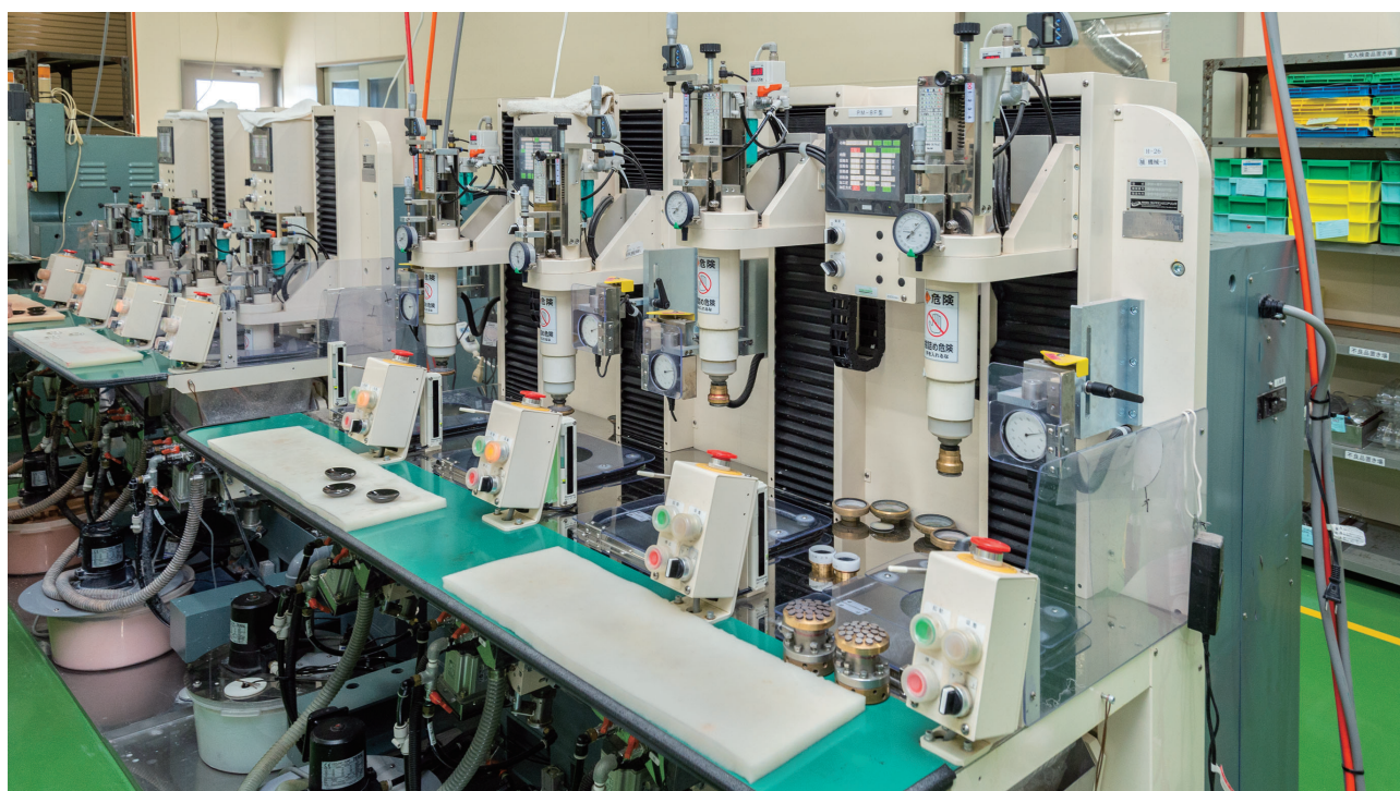
NC搭載の精研削・ダイレクトスムージング装置。4工程だった研磨作業が1工程カットされることで時短になる
