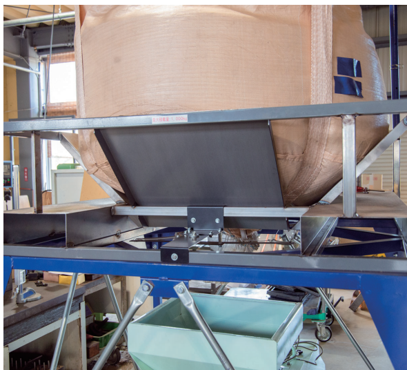
フォークリフトで、フレコンバックをフレコン用フレームの上のせ、土や米、肥料などの排出作業を行う
