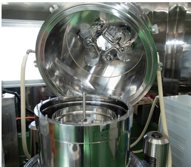
密閉空間で上槽・分離されるため香りの劣化が少なく高品質の日本酒ができる
