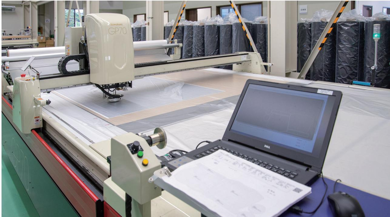
導入したパソコン掲載機の自動延反機、持ち運び可能なタブレットでの操作も可能
