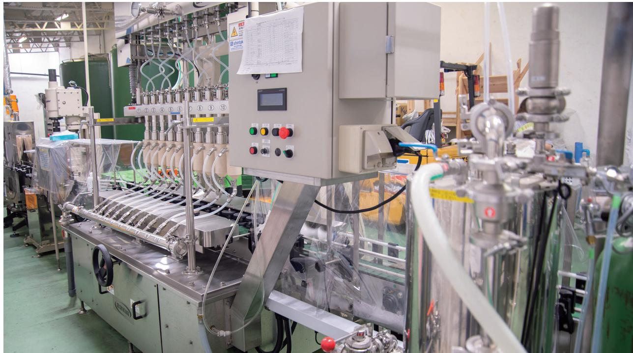
炭酸ガス注入充填と通常充填が使い分けられる微炭酸ガス充填機を導入
