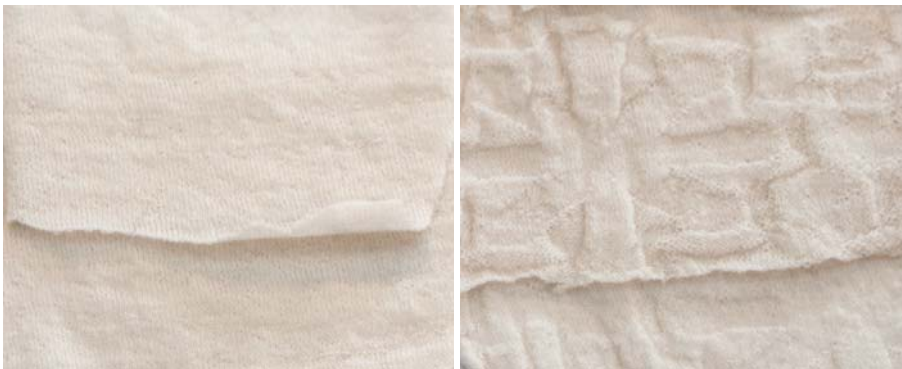
18ゲージの編み機で編んだフォークランド産ウールのサンプル
