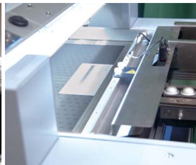
給紙部の後のコンベアに検知カメラを上下に搭載してある。
