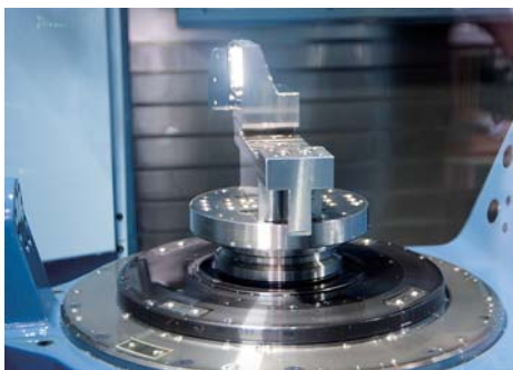
3軸から5軸対応機で複雑形状の部品製造の時間が短縮される。
