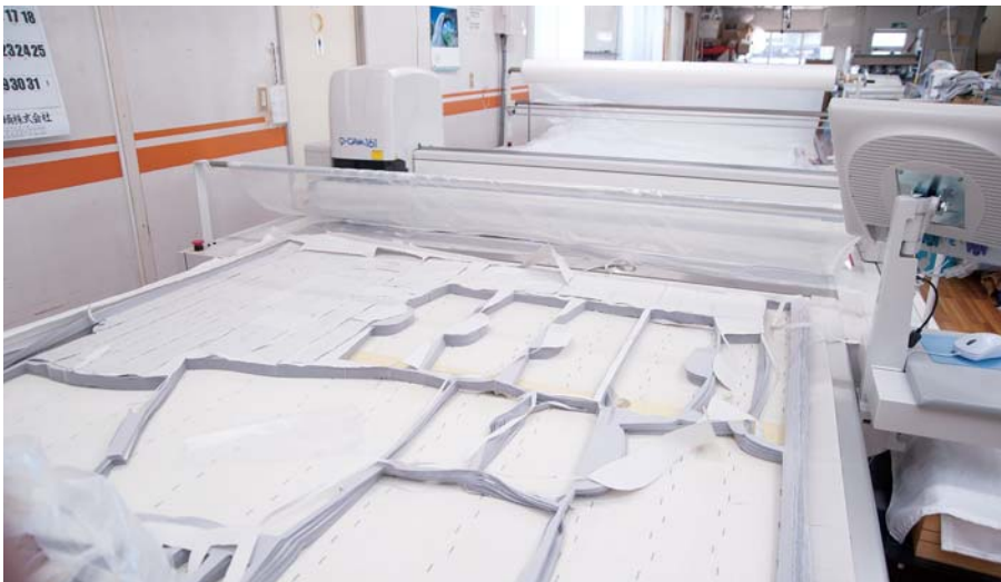
CAM・CAD自動裁断機導入でミリ単位まで正確に裁断。品質クオリティ、生産性の向上。
