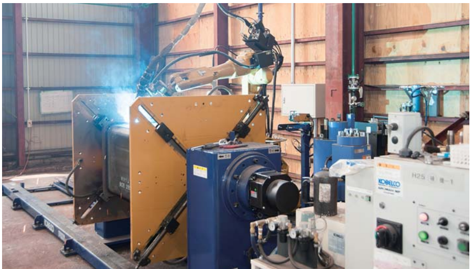
コア連結連続溶接ロボットシステム
