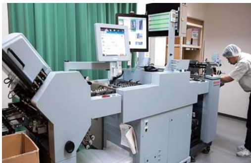
検知カメラ搭載の新型折機。
