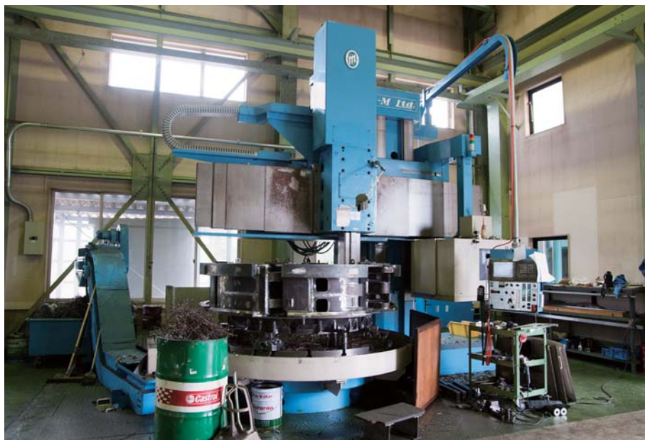
これまでより大型・高精度の加工に対応可能な、CNC制御立型旋盤。
