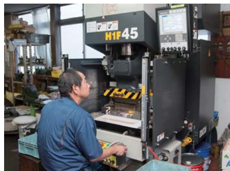
加圧時間を可変できるサーボプレス機。
