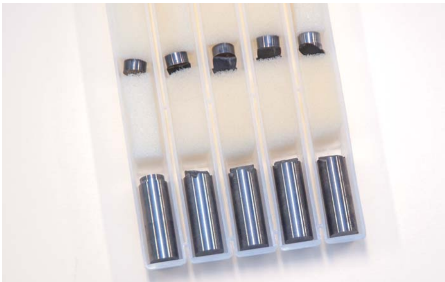
試作テスト ロウ付けの強度が高く、超硬ボディーの方が切断されてしまったものも
