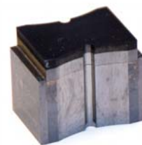
加工テスト形状 上の部分がPCD、下が超硬ポディー、 間をロウ付けしている
