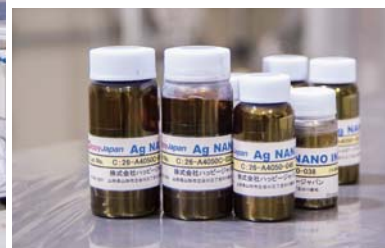
銀ナノ粒子を用いた導電性インク
