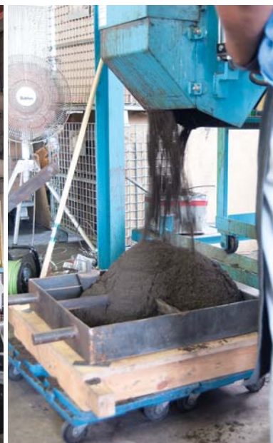
再生砂を用いた高強度鋳型の製作。
