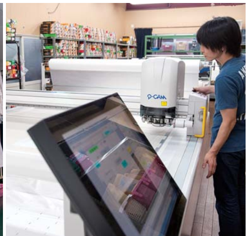
従来手作業で多くの人手を必要としていたが、現在は一人のスタッフで断裁作業を担当。
